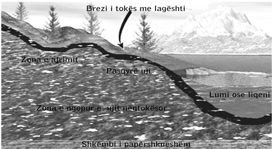
Fig. 5.9 Skemë e ujit nëntokësor
