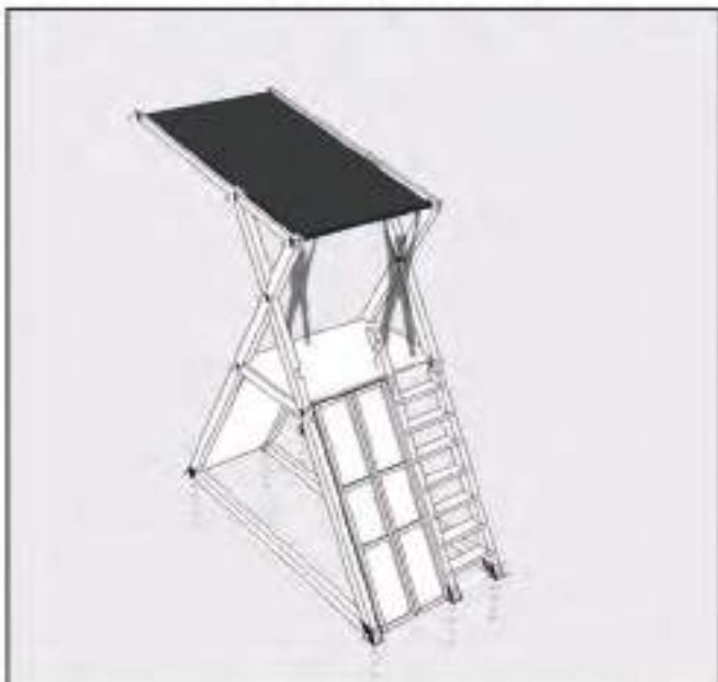
9. MONTOHEN PANELET VESHES ME KOMPESATE DHE BANER PVC.
