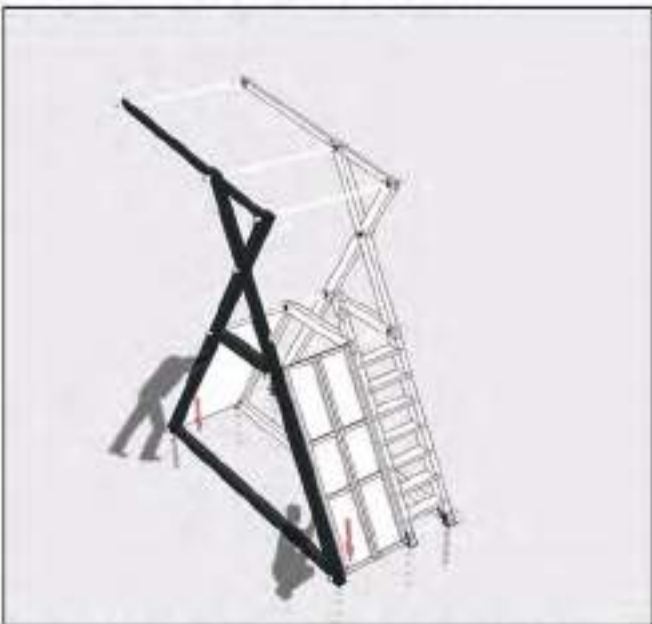
7. FIKSOHEN ELEMENTET E ANES TJETER TE STRUKTURES.
