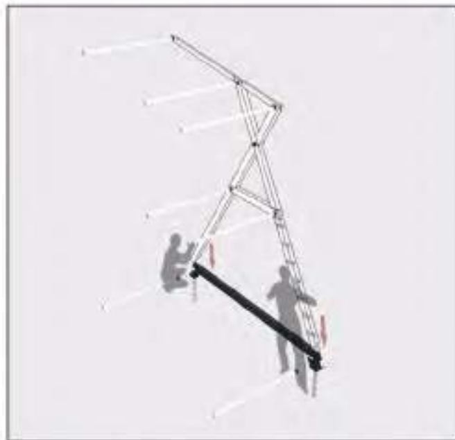
4. NGRIHET STRUKTURA VERTIKALISHT DHE FIKSOHET NE PILOTA.
