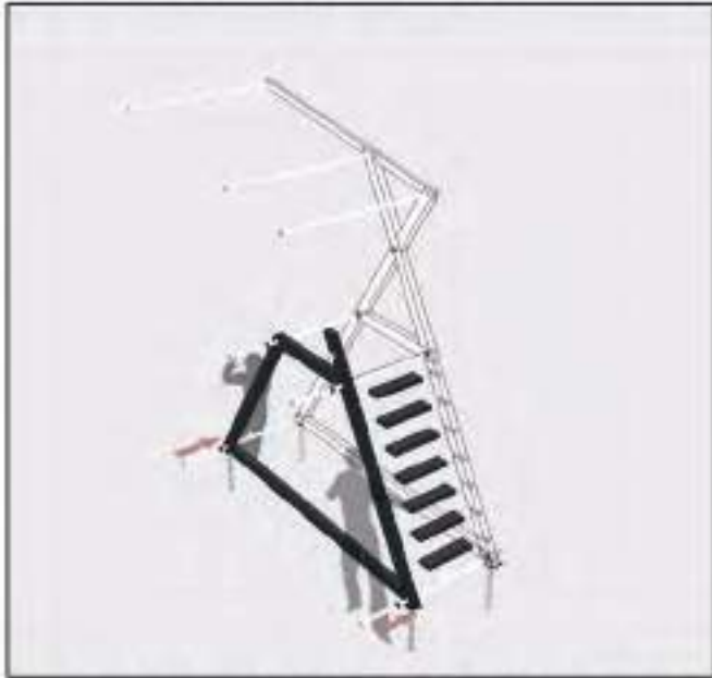
5. FIKSOHEN ELEMENTET E SHKALLEVE ME STRUKTUREN NE MES.
